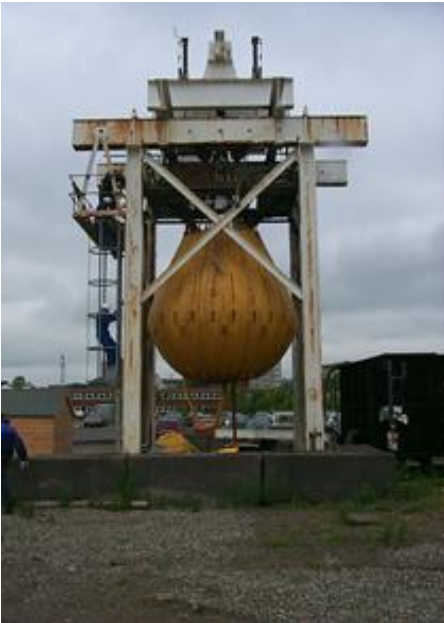
Drop Test @ NEL to Prove 6:1 Load
